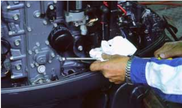
オイル量計測状況
