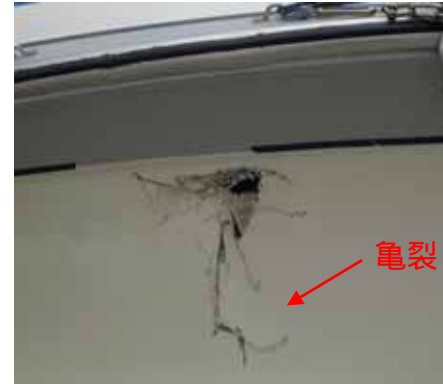
船体破損状況
