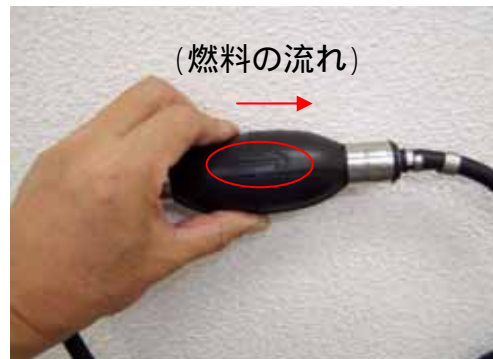
プライマリポンプ(船外機)
