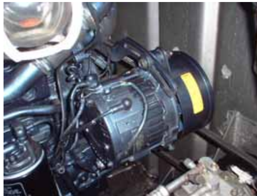
発電機（オルタネーター）
