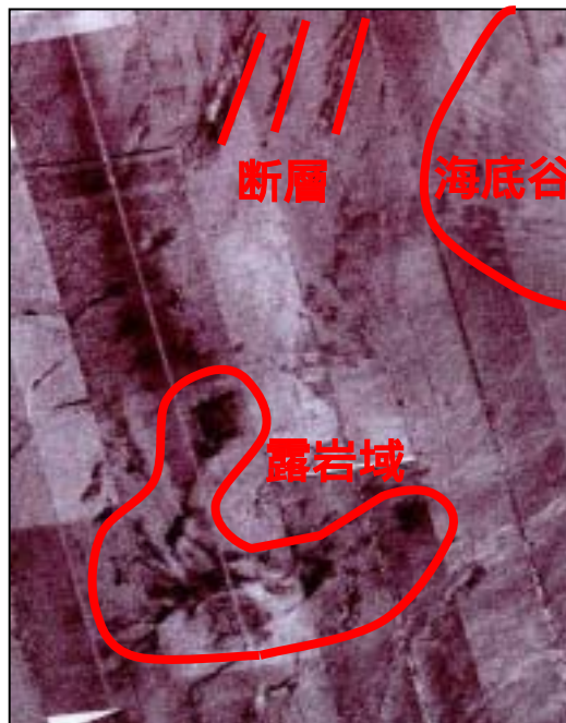
図2 海底音響画像（福島沖） 音響信号の反射強度の高いところは色が黒くなっている。
