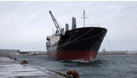
強風・波浪により係留索が切れ 係留困難となった状況
