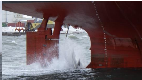
バラスト調整が不十分でプロペラ レーシング(空回り)している状況
