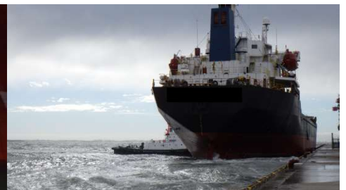
係留索が切れて係留状態が保持できず、 タグボートにより岸壁に押し付けている状況
