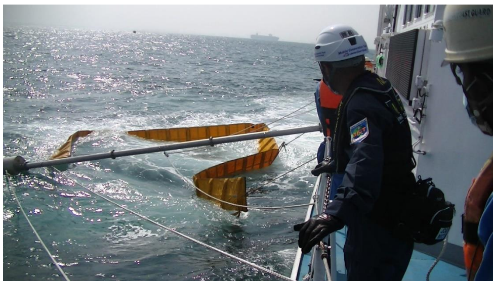
油防除資機材を使用した流出油（模擬）回収の状況
