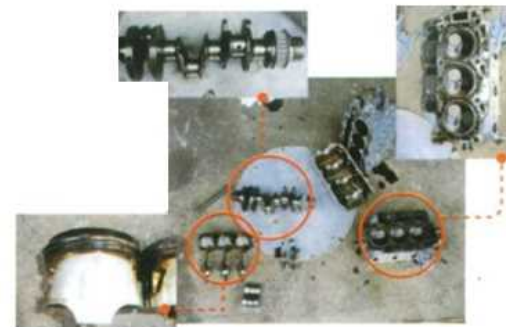
【エンジンオイル不良によるエンジンの損傷】
