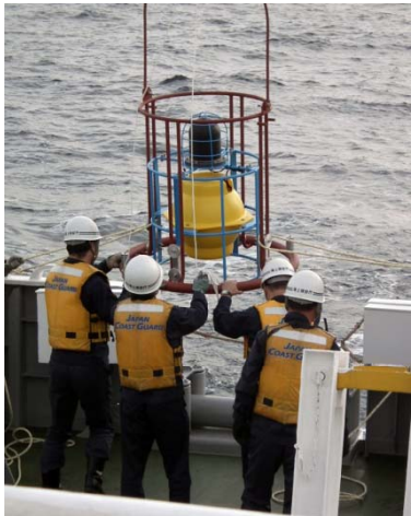
海底基準局の投入作業
