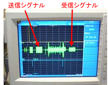
観測した音響測距波形 (送受信の時間差から距離を測定)
