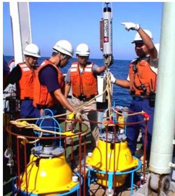
海底基準局の投入作業
