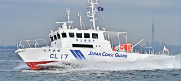
CL型 巡視艇なちかぜ 全長：18.0m 最大幅：4.3m 総トン数：19t
