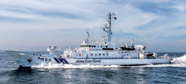
PM型 巡視船ちとせ 全長：72.0m 最大幅：10.0m 総トン数：650t
