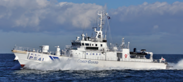
PS型 巡視船かむい 全長：43.0m 最大幅：7.8 m 総トン数：200t
