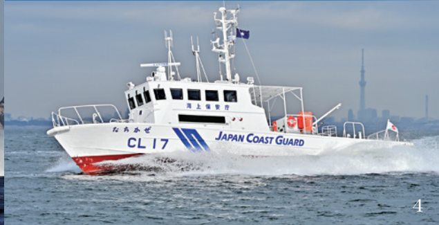
CL型 巡視艇なちかぜ 全長：18.0m 最大幅：4.3m 総トン数：19t
