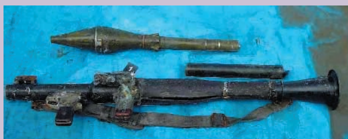
上の発射装置から砲弾部を取り外して発射薬筒部を分離したもの
