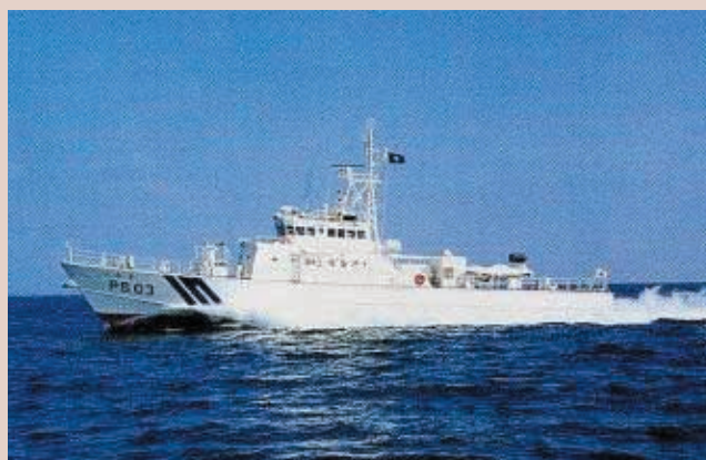
巡視船 いなさ PS-03 総トン数 181トン、全長 43.0メートル 所属 長崎海上保安部、 武器 20ミリ機関砲、小銃、けん銃
