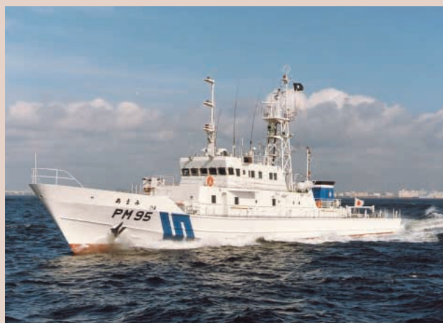
巡視船 あまみ PM-95 総トン数 249トン、全長 56.0メートル 所属 名瀬海上保安部、武器 20ミリ機関砲、小銃、けん銃
