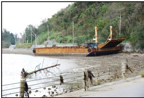
錨泊中、強風により走錨した作業用船舶が乗揚げ
