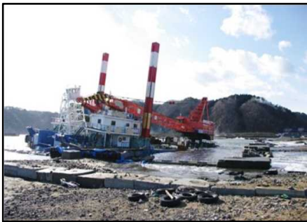
錨泊中、強風により走錨した作業用船舶が乗揚げ
