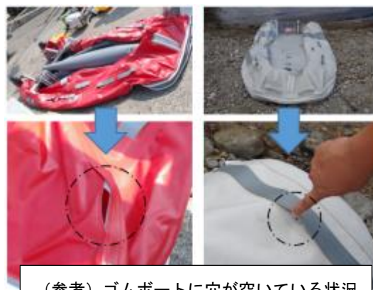
（参考）ゴムボートに穴が空いている状況
