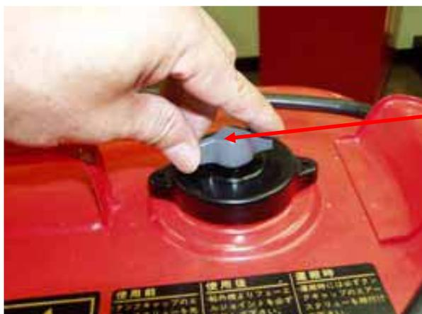
燃料タンク空気抜きバルブ
