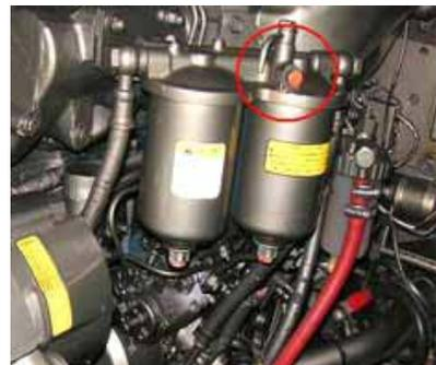
フィルター空気抜きプラグ（船内機）
