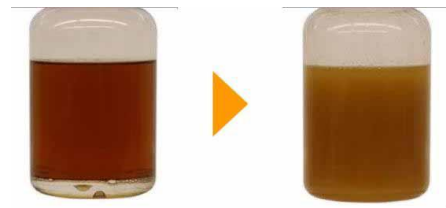
正常 オイルの性状 乳化
