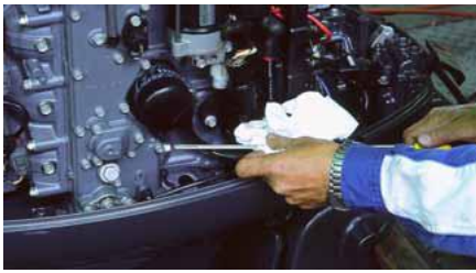
オイル量計測状況
