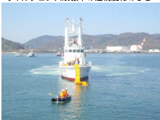
オイルフェンス展開中の巡視艇ぬのびき
