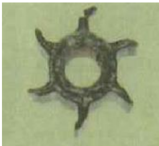
磨耗と破損したインペラ
