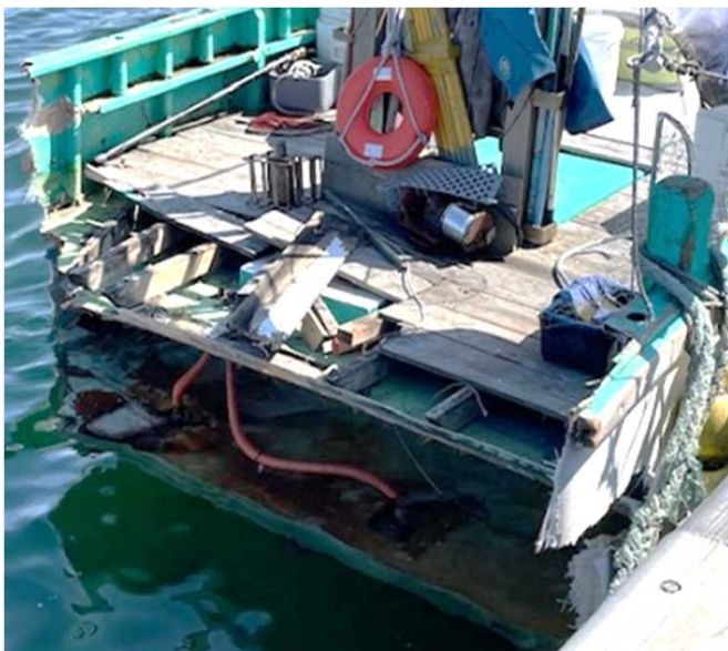
遊漁船① 船尾の損傷状況
