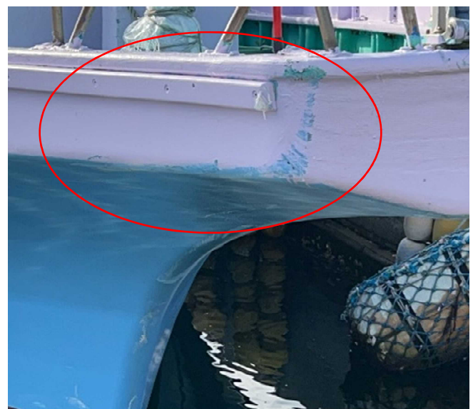
遊漁船② 船首の損傷状況
