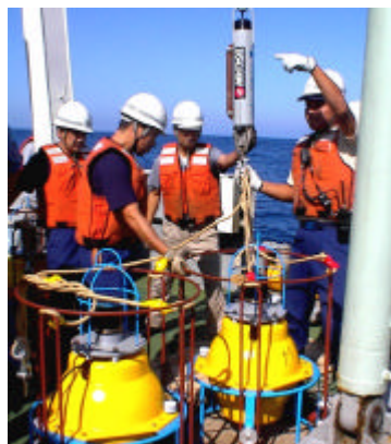
海底基準局の投入作業
