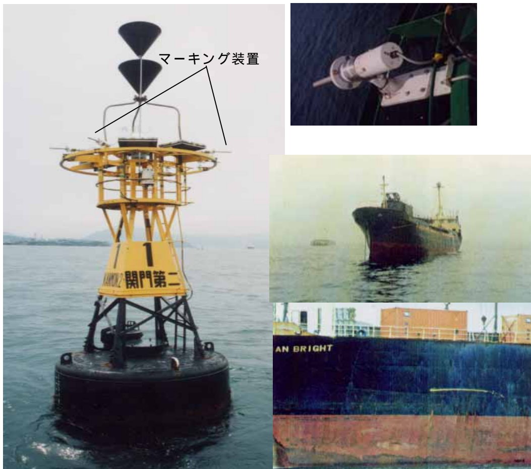
マーキング装置取付状況 関門第二航路第一号灯浮標（若松）
