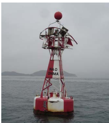
灯浮標の破損事故事例 直島北西灯浮標（香川）
