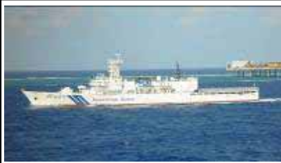
巡視船せつ (神戸海上保安部所属) 3100総トン、速力約22ノット 35ミリ、20ミリ機関砲搭載
