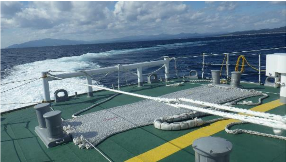
救助船である巡視船おくしり後部甲板に漂流船をえい航するための 直径45mmのえい航索200mをスネークダウンと呼ばれる方法で整理
